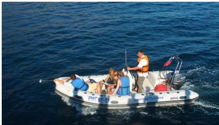
Рис. 96. Магниторазведка с плавсредств для определения характера донных отложений и тектонических нарушений на береговом склоне
