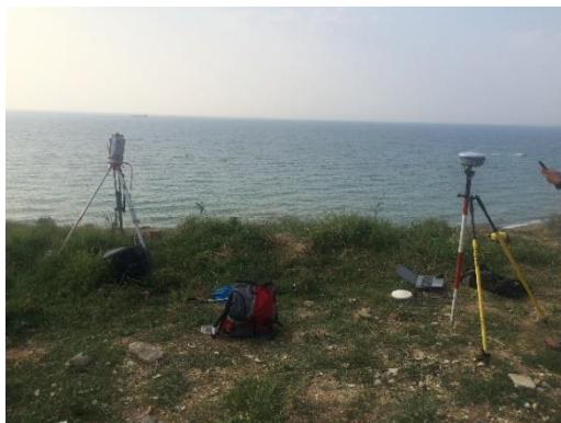
Рис.98 Лазерное сканирование береговой зоны в районе НОП Учкуевка
