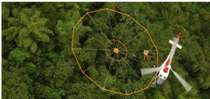
Рис.36. Аэроэлектроразведочный комплекс VTEM фирмы Geotech.
