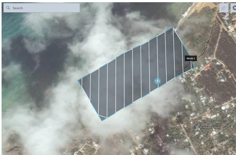
Рис.100. Снимок маршрутного задания БПЛА с экрана управляющего устройства, осуществляющего съемку оползневого склона в районе НОП «Учкуевка».
