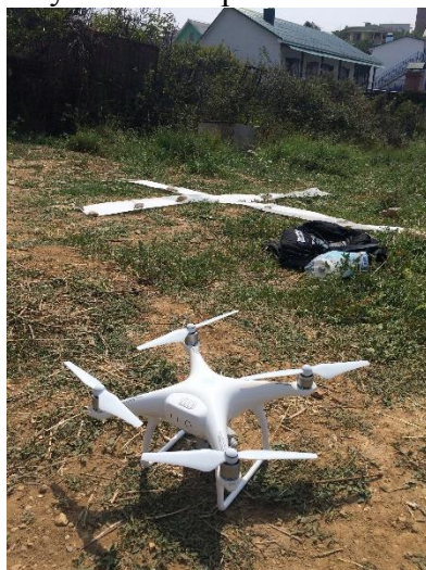
Рис. 99. Инструментальная съемка оползневого склона в районе НОП «Учкуевка» квадрокоптером Phantom 4 поколения с ПО, позволяющим создавать 3 D модели местности.
