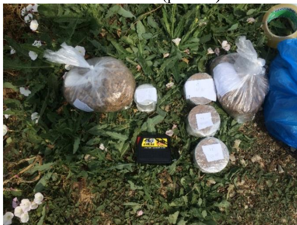
Рис. 93. Отбор проб грунтов нарушенного и ненарушенного сложения для определения физических свойств механических свойств
