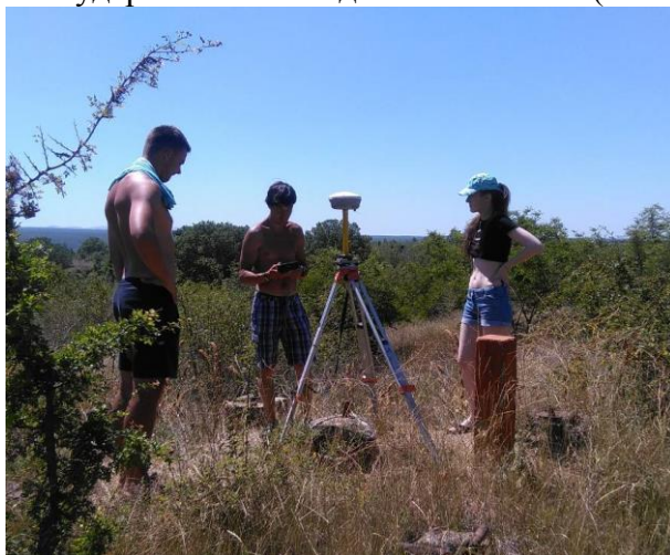
Рис. 26. Измерения планово-высотного положения опорного пункта Государственной геодезической сети – Верхнесадовое (Бахчисарайский район). [Фото Косевич Н.И.]
