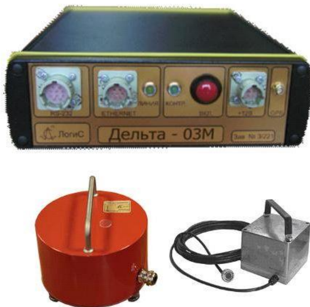
Рис. 42. Комплект автономной сейсмологической аппаратуры для регистрации параметров вибрационного поля.
