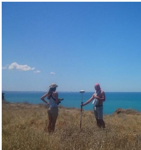
Рис.97. Проведение инструментальной съемки методом спутниковой геодезии в районе НОП Учкуевка.
