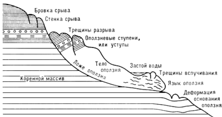
Рис. 20. Продольный разрез оползня [8].
