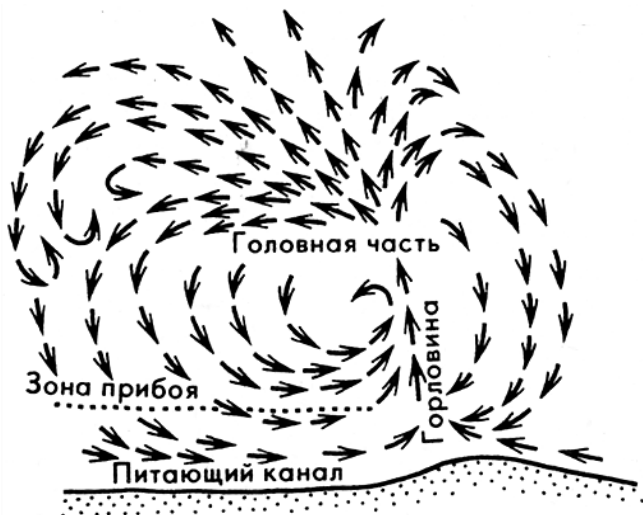
Рис. 7. Схема разрывного течения [7]
