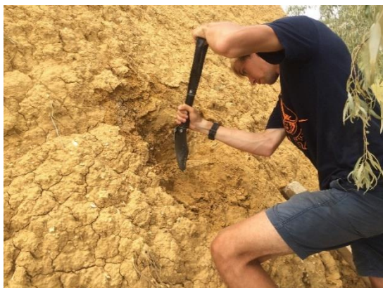
Рис.92. Отбор монолита грунта из оползневого останца в береговой зоне НОП Учкуевка.
