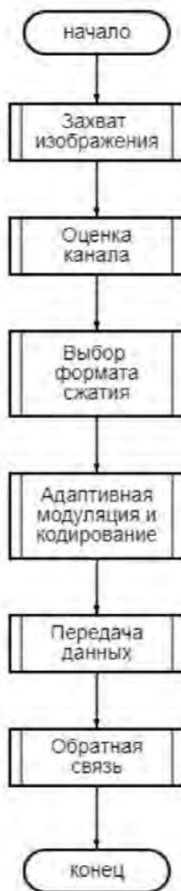
Рис. 1. Обобщённая блок-схема предложенного алгоритма передачи изображения с борта БПЛА
