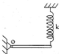
5. Однородный тонкий стержень массы  $m$  совершает малые колебания вокруг горизонтальной оси, проходящей через его левый конец (т. О). Правый его конец подвешен на невесомой пружине жесткости  $k$ . В положении равновесия стержень горизонтален. Каков период колебаний стержня?
