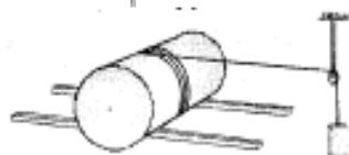
4. На двух параллельных горизонтальных брусках лежит однородный цилиндр массы  $m$  и радиуса  $R$ , на который намотана нить. К концу нити прикреплен груз массы  $M$ . Нить переброшена через легкий блок. Найти ускорение  $a$  груза. (Качение цилиндра по брускам происходит без скольжения.)
